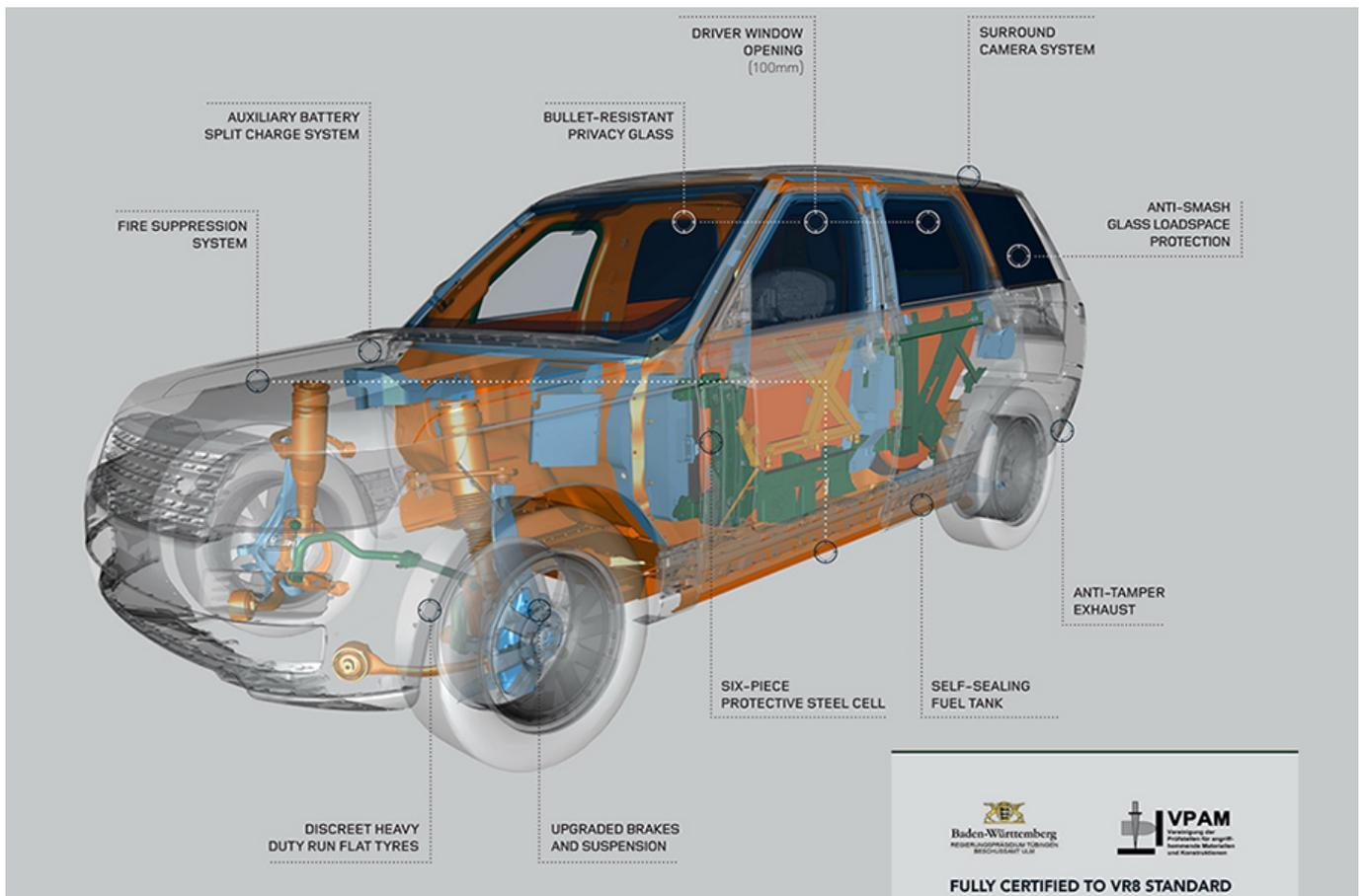
**Range Rover Sentinel, version blindée dédiée à la personnalisation et aux séries limitées. La cabine est faite d'acier à très haute résistance, le verre a été remplacé par un vitrage teinté renforcé et les pneus, montés sur des jantes de 20 pouces, disposent d'une structure "run-flat" permettant de rouler à plat. Réservoir à verrouillage automatique et système d'échappement spécifique complètent la panoplie.**
